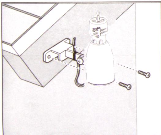
Датчик Дождя также может быть установлен на любой подходящей твердой поверхности, такой как сторона крыши, сарая или забора. Используйте для крепления два винта нержавеющей стали, поставляемых в комплекте.
