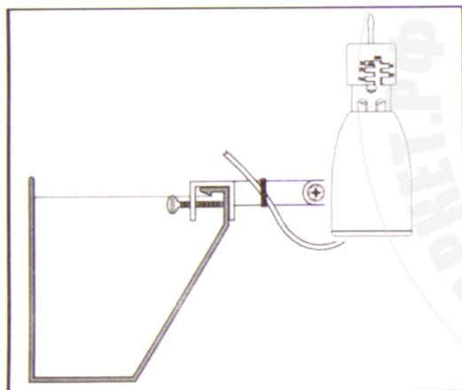
Идеальным местом монтажа датчика дождя является внешняя сторона водостока. Установите скобу крепления на край водостока и зафиксируйте датчик.
